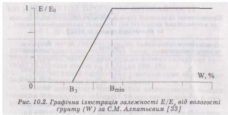
Рис. 10.2. Графічна ілюстрація залежності  $E/E_0$  від вологості ґрунту ( $W$ ) за С.М. Алпат'євим [33]
