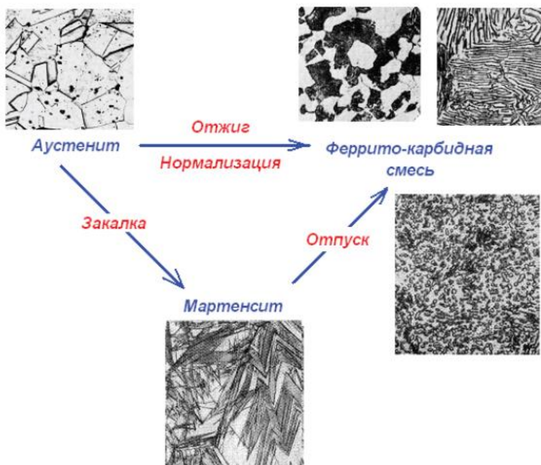
Рис. 2. Обобщенная схема термической обработки стали
